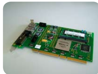
Carte PCI ARION 100 utilisant la technologie SOPC - Carte de communication Temps Réel
