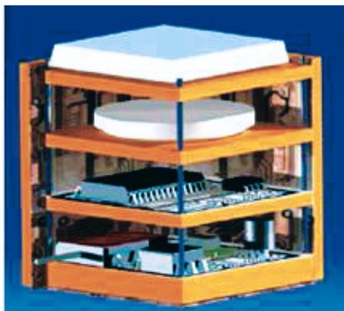
Figure 5. Assemblage 3D du microsystème (projet SMARTGEC).
