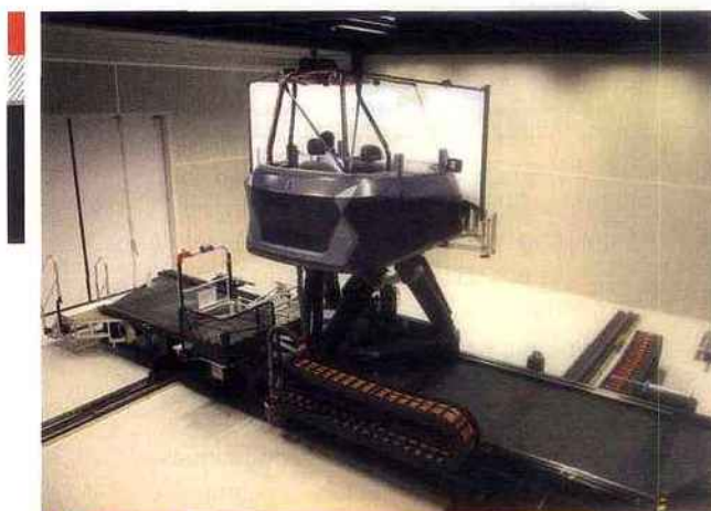
Renault utilise des simulateurs de conduite dynamiques dotés d'un affichage en réalité virtuelle avec affichage à 200°. Ultimate dispose d'une plate-forme mobile 6 axes posée sur une table XY de 7m de côté.
