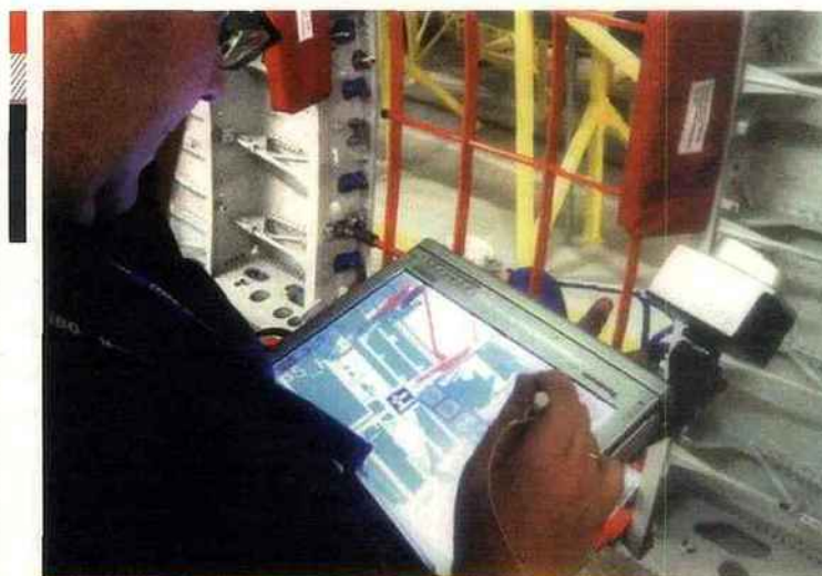
Airbus utilise l'application de réalité augmentée Mira sur tablette pour contrôler certaines opérations de fabrication, telle la pose de rivets.
